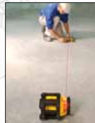
Niwelowanie pionowe: Ze statywu za pomocą zawartego w zakresie dostawy metalowego pałaka lub bezpośrednio na podłożu.
