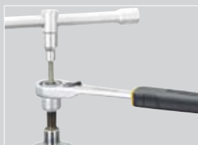
Przy montażu amortyzatorów wstrząsowych (najczęściej 22 mm).
