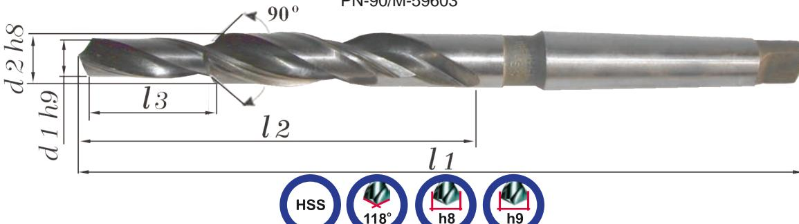
Wiertła kręte stopniowe z chwytem stożkowym Morse'a do otworów pod gwinty metryczne. Wykonane metodą szlifowania.
