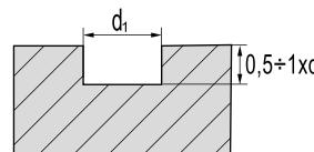
Frezy wykonywane w tolerancji e8 są przeznaczone do frezowania rowków na wpuści w tolerancji P9;
