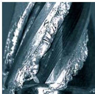
Pilnik niepowlekany - widoczny narost
