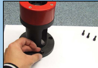
Fot.2. Montaż śrub w przyrządzie
