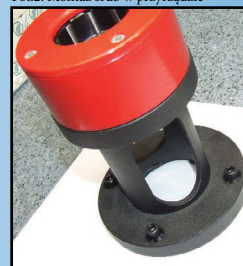
Fot.3. Przyrząd zamontowany do stołu (należy pamiętać, aby korzystać z odpowiednich śrub i dokręcić je na tyle, aby przyrząd stał stabilnie)
