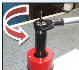
Fot.10. Odkręcanie nakrętki kluczem dynamometrycznym
